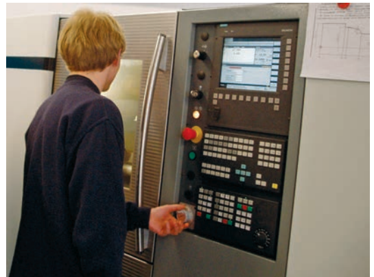
2 Einrichtearbeiten an der CNC-Maschine
