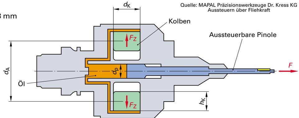
Das Aussteuern erfolgt unter Verwendung der bei der Rotation des Werkzeuges durch zwei symmetrisch angeordnete Kolben entstehenden Zentrifugalkraft. Das Werkzeug steuert nach Abbremsen der Spindel automatisch über Federkraft ein.
